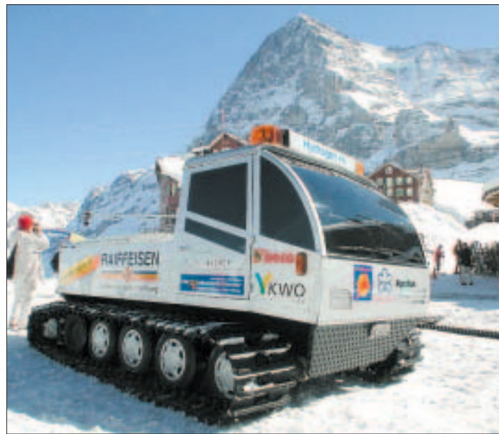
Nachher: Mechaniker Jakob Hertig und Designer Ulo Gertsch bauten den alten Ratrack zum sauberen H 2 -Pistenbully um.
